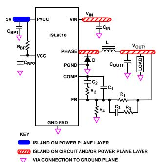
FIGURE 32. PRINTED CIRCUIT BOARD POWER PLANES AND ISLANDS
