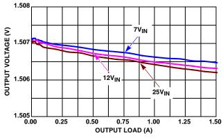
FIGURE 7. V<sub>OUT</sub> REGULATION vs LOAD, 500kHz 1.2V<sub>OUT</sub>
