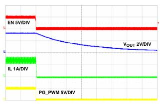
FIGURE 24. SHUT DOWN CIRCUIT, 100µs/DIV
