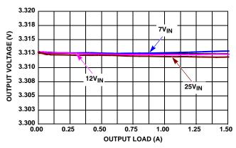
FIGURE 10. V<sub>OUT</sub> REGULATION vs LOAD, 500kHz 3.3V<sub>OUT</sub>
