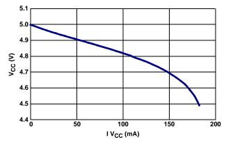
FIGURE 15. V<sub>CC</sub> LOAD REGULATION
