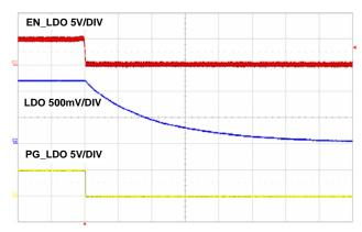
FIGURE 25. SHUT DOWN CIRCUIT, 20µs/DIV
