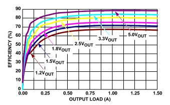
FIGURE 5. EFFICIENCY vs LOAD, V<sub>IN</sub> = 25V
