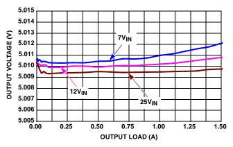
FIGURE 11. V<sub>OUT</sub> REGULATION vs LOAD, 5V<sub>OUT</sub>
