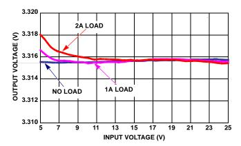
FIGURE 14. OUTPUT VOLTAGE REGULATION vs  $V_{\mbox{\scriptsize IN}}$
