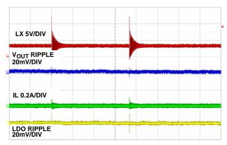
FIGURE 18. STEADY STATE OPERATION AT NO LOAD, 20µs/DIV
