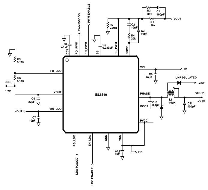
FIGURE 1. V<sub>IN</sub> RANGE FROM 4.5V TO 5.5V
