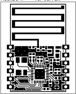
FIGURE 2-5: LAYER 2 — GROUND PLANE
