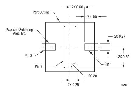
Figure 7. SMP1330-085LF PCB Layout Footprint
