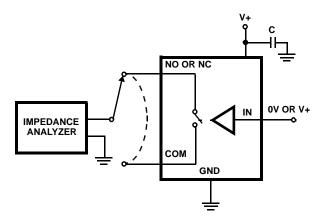
FIGURE 5. CAPACITANCE TEST CIRCUIT
