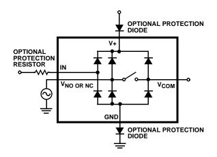
FIGURE 6. OVERVOLTAGE PROTECTION
