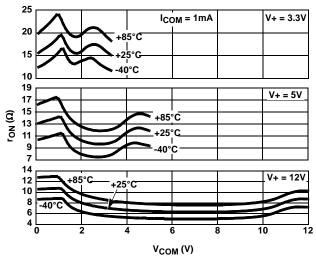
FIGURE 8. ON-RESISTANCE vs SWITCH VOLTAGE
