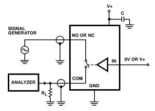
FIGURE 3. OFF-ISOLATION TEST CIRCUIT
