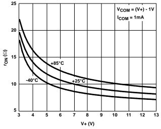
FIGURE 7. ON-RESISTANCE vs SUPPLY VOLTAGE
