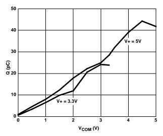
FIGURE 9. CHARGE INJECTION vs SWITCH VOLTAGE
