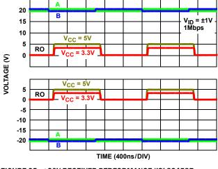
FIGURE 25. ±20V RECEIVER PERFORMANCE (ISL32453E, ISL32455E)
