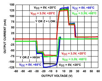
FIGURE 17. DRIVER OUTPUT CURRENT vs SHORT-CIRCUIT VOLTAGE
