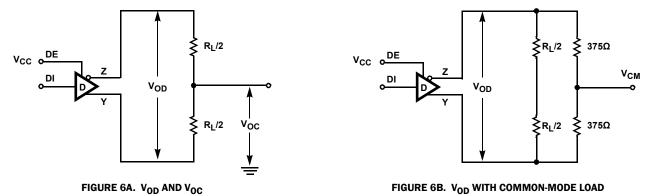
FIGURE 6. DC DRIVER TEST CIRCUITS
