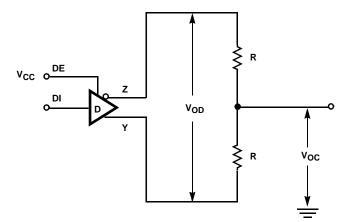
FIGURE 1. DRIVER  $V_{\mbox{OD}}$  and  $V_{\mbox{OC}}$
